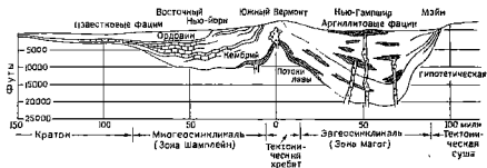
Рис. 16-2. Реконструированный профиль кембрия и ордовика через многогеосинклиналь и эвгеосинклиналь от Нью-Йорка до Мэйна. По [31] (1 миля = 1,6 км; 1 фут = 0,3 м)
