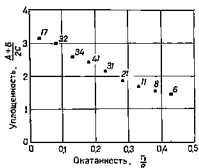
Рис. 3-21. График соотношения между окатанностью и уплощенностью, построен по результатам измерений 201 гальки, пляж Нантакет, штат Массачусетс, США По Ун-туарту [334].
